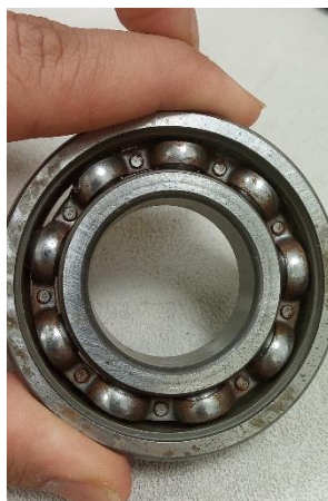
شکل ۵- بیرینگ آسیب دیده مربوط به سر غیر درگیر الکتروموتور MP-1106B
